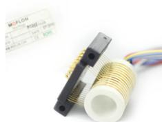
MSP112 分体式滑环是属于微型滑环一种，采用分离的转子和接触刷组合，支持12路信号/2A,定子线和转子线对应使用12色彩色导线，使电路连接简单化。导电环采用90度角V型槽设计，具有顺畅旋转，低力矩和低电气噪音的特点，从而性能超越普通的滑环产品。
